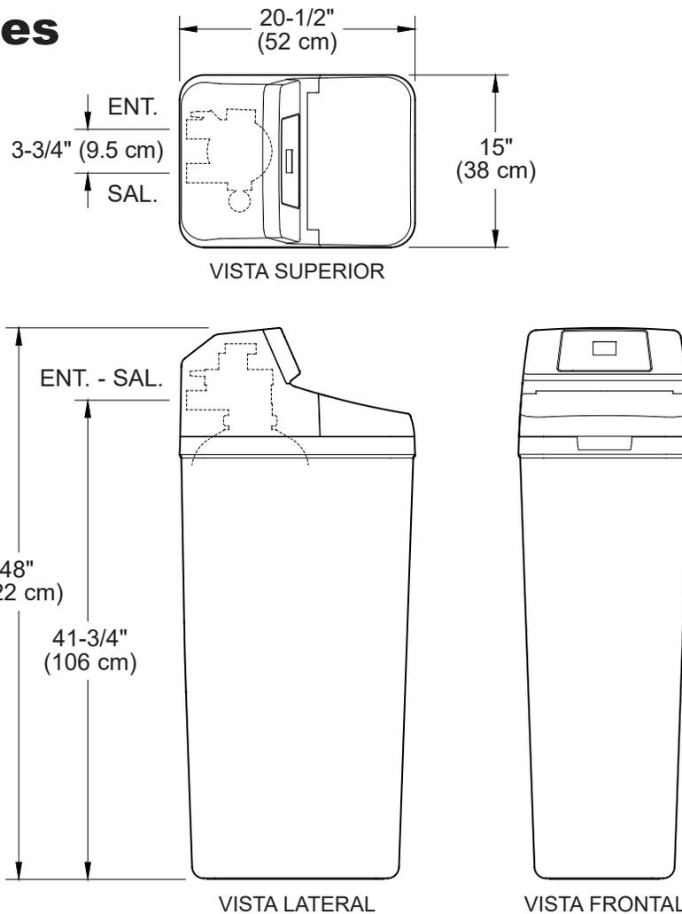
**NOTA:** Debido a variaciones en la producción y el ensamblaje, la altura de la válvula del ablandador de agua puede variar hasta en 1/2", y puede no coincidir con los sistemas instalados anteriormente. Esto no afectará al rendimiento del sistema.
