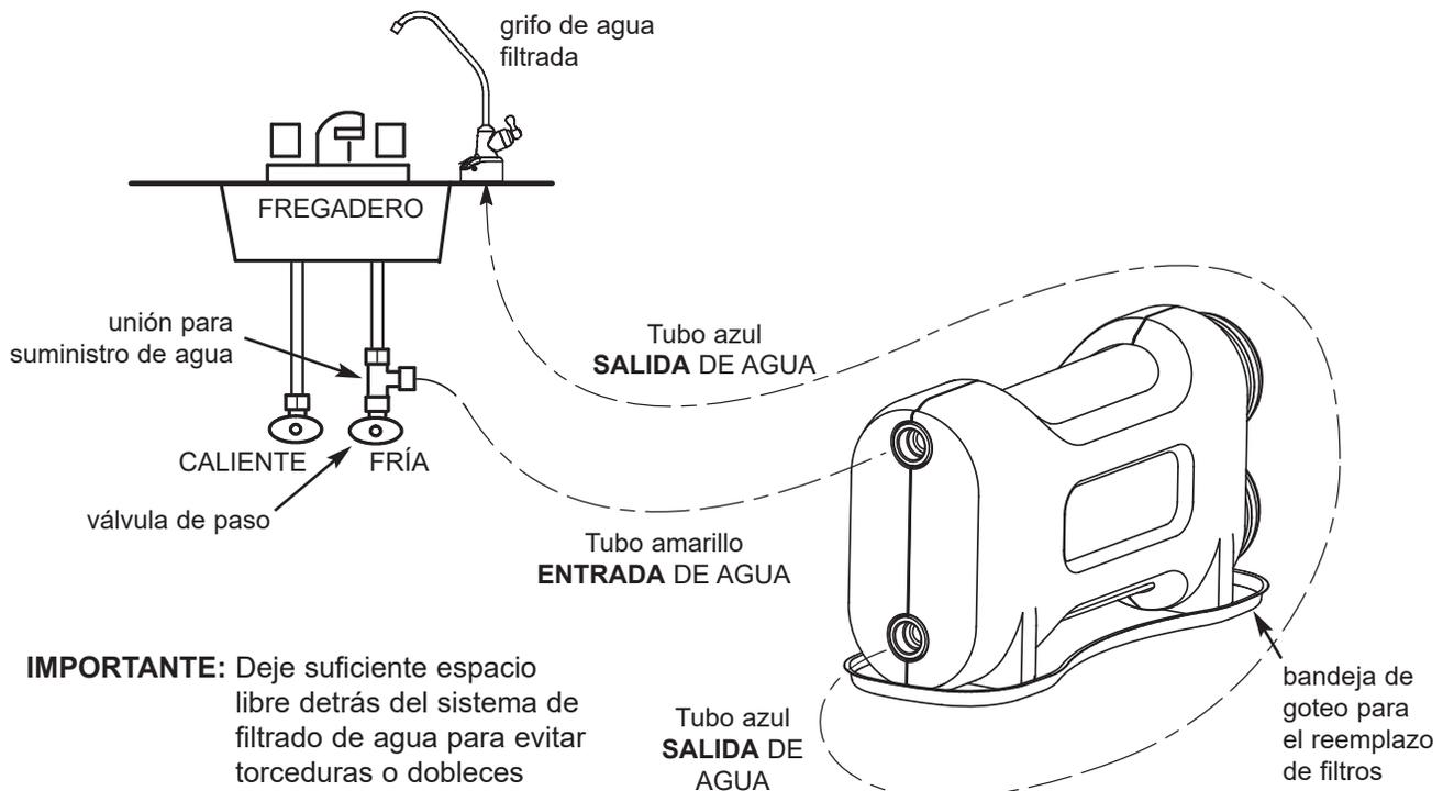
**IMPORTANTE:** Deje suficiente espacio libre detrás del sistema de filtrado de agua para evitar torceduras o dobleces pronunciados en la tubería.
