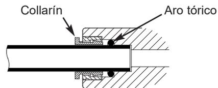
Tubo totalmente acoplado a la unión FIG. 20
