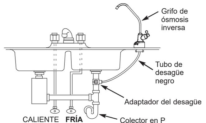
**IMPORTANTE:** No instale el adaptador de desagüe debajo del colector en P. Ubique el adaptador de desagüe de modo que, cuando se instale el tubo de desagüe negro proveniente del grifo de ósmosis inversa, se extienda recto hacia el adaptador, sin caídas, bucles ni dobleces.
