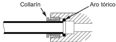
Tubo parcialmente acoplado a la unión FIG. 19
