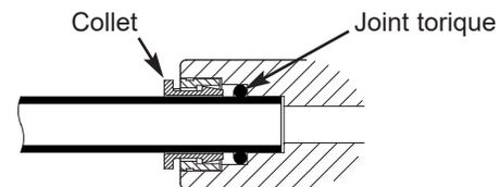
Tuyau totalement inséré dans le raccord
