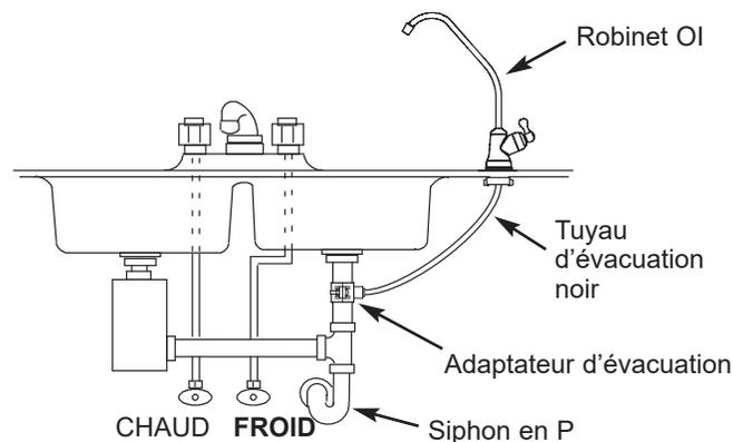
**IMPORTANT :** N'installez pas l'adaptateur d'évacuation en dessous du siphon en P. Orientez l'adaptateur de manière à ce que le tuyau d'évacuation noir du robinet OI, après son raccordement, s'y dirige tout droit, sans dépressions, boucles ou coudes.
