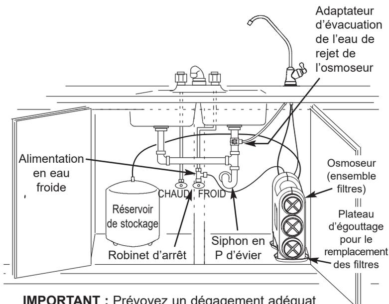
**IMPORTANT :** Prévoyez un dégagement adéquat derrière le système de filtration d'eau pour éviter les coudes ou pliures des tuyaux.
