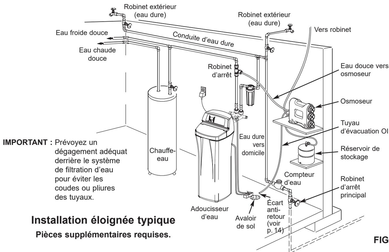
**IMPORTANT :** Prévoyez un dégagement adéquat derrière le système de filtration d'eau pour éviter les coudes ou pliures des tuyaux.
