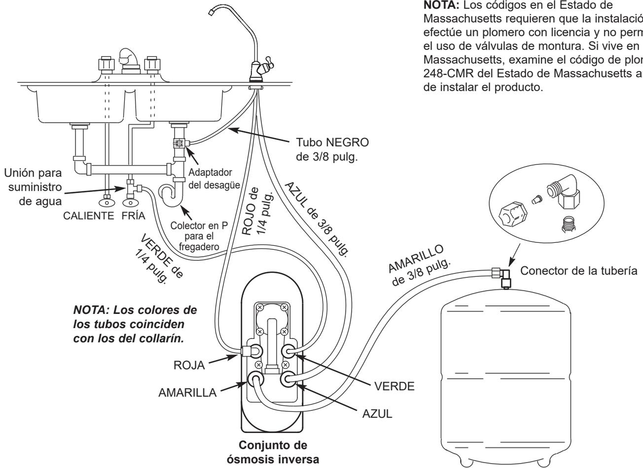
**NOTA:** Los códigos en el Estado de Massachusetts requieren que la instalación la efectúe un plomero con licencia y no permiten el uso de válvulas de montura. Si vive en Massachusetts, examine el código de plomería 248-CMR del Estado de Massachusetts antes de instalar el producto.
