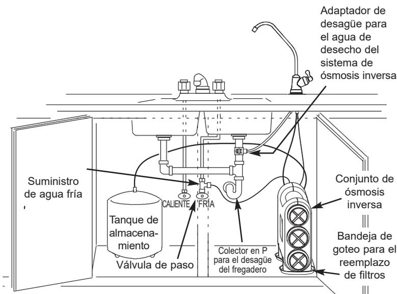
**IMPORTANTE:** Deje suficiente espacio libre detrás del sistema de filtrado de agua para evitar torceduras o dobleces pronunciados en la tubería.
